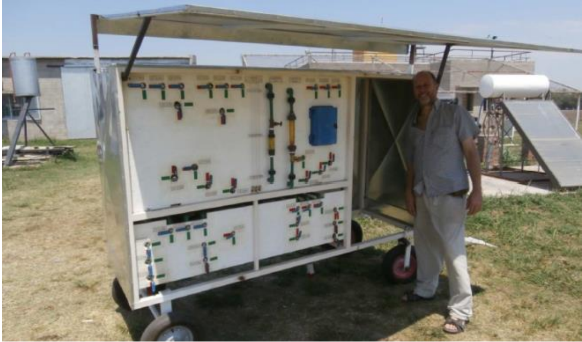
Fig. 8.4. Vista del panel de control de una máquina de ensayos múltiples para colectores de agua caliente y sistemas completos prefabricados.
