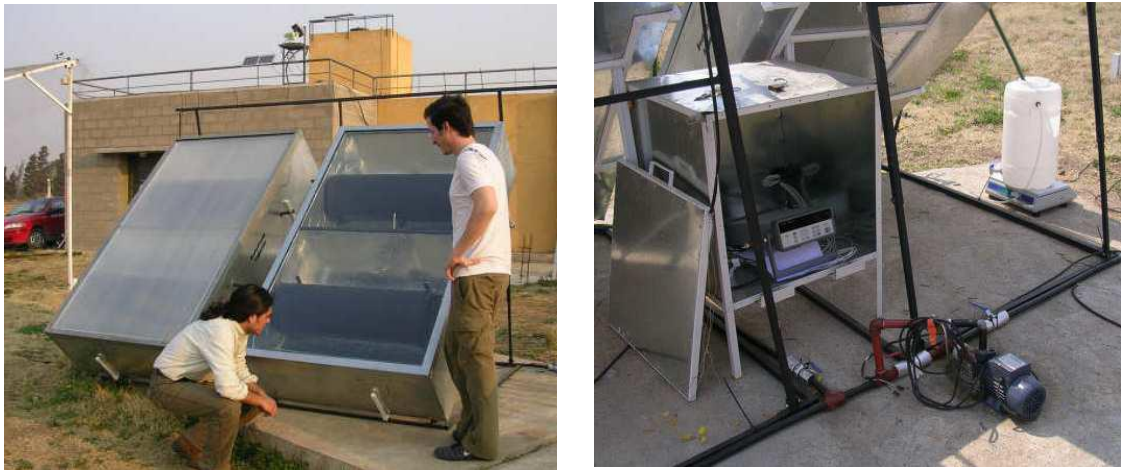
Fig. 6.10. (a) Prototipos de CAIBR con distintas cubiertas transparentes; (b) Sistema común para adquisición de datos.
